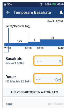
3 > Tippen Sie auf das Eingabefeld Basalrate und wählen Sie Ihre Änderung in Prozent. Tippen Sie auf das Eingabefeld Dauer und wählen Sie die Zeitspanne aus
